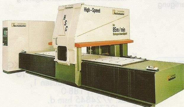
Abb. 1: CNC-Maschine für das Hochgeschwindigkeitsfräsen
