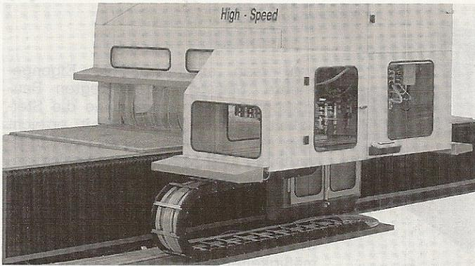
Abb. 7: Schalteinrichtung mit Annäherungsreaktion (Beispiel Safety-Bumper)
