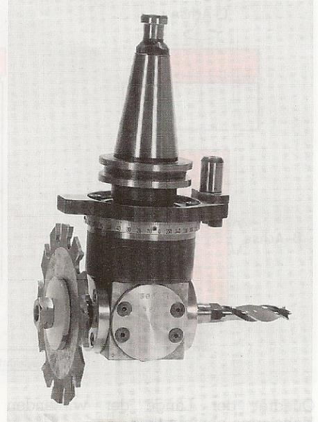
Abb. 9: SK40-Winkelbohr- und -Sägeaggregat
