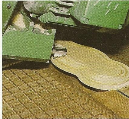
Abb. 6: NC-Fräsggregat für Spezialprofile
